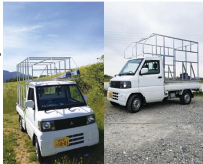
それぞれの使用目的に合わせて製作するオーダー製品は、アルミの鍛冶屋が得意とするところ。車になるべく負担をかけないで思いを実現する為、軽量で鋲びに強く、自由な加工のし易いアルミでオーナー様のどんな要求にも応えていきます。
